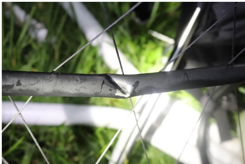
Rys. 5. Uszkodzenie kosza spowodowane uderzeniem obracającego się śmigła [źródło: Policja]
