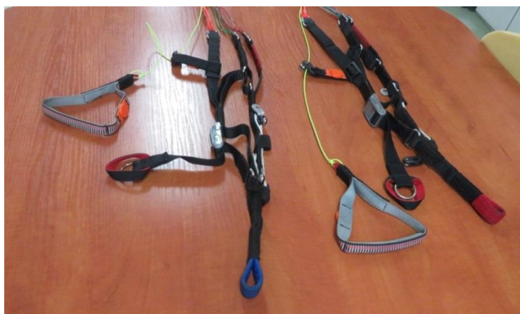
Rys.6. Na zdjęciu widoczne są taśmy skrzydła motoparalotni. Widać symetrycznie zaciągnięte tryмеры [źródło: PKBWL]
