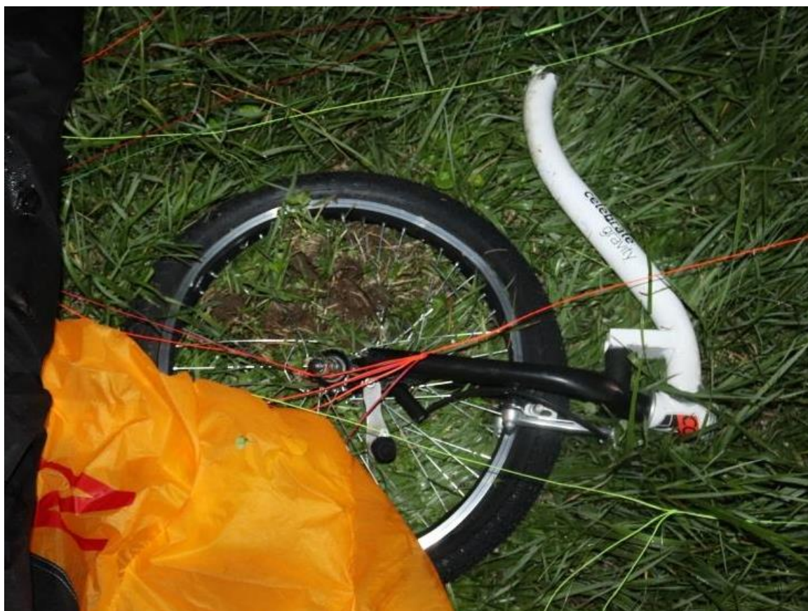
Rys. 4. Wyłamane przednie koło wózka [źródło: Policja]
