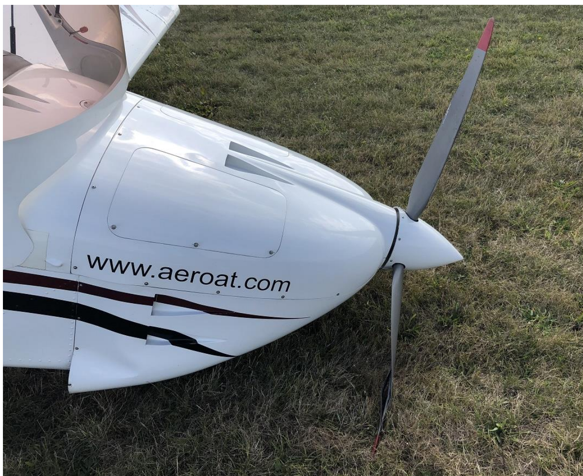
Obraz 5. Samolot AT-3 na płycie lotniska tuż po zdarzeniu – widok na uszkodzone śmigło i maskę silnika [źródło: użytkownik]
