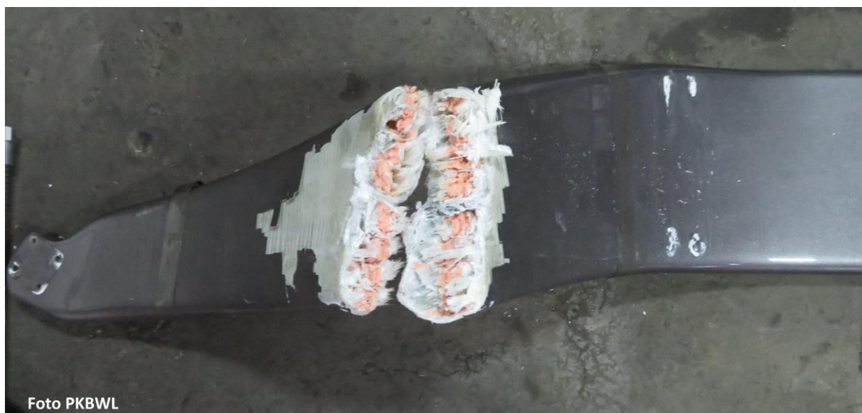
Rys.6. Miejsce złamania lewej goleni podwozia samolotu.
