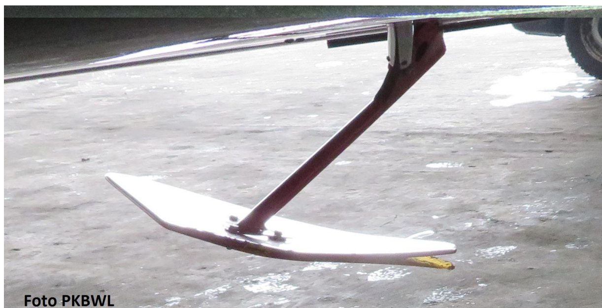
Rys. 8. Na zdjęciu widać wygięte i rozwarstwione wyważenie lewej lotki.
