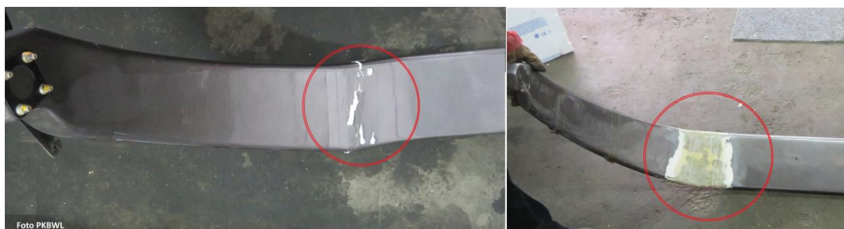
Rys. 5. Na zdjęciach pokazano: po lewej stronie pękniętą goleń z samolotu, który brał udział w incydencie a po prawej miejsce uszkodzenia goleni z innego samolotu tego typu.
