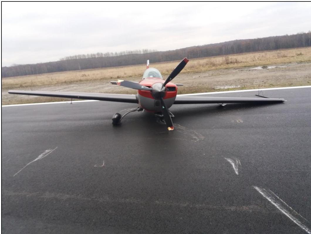
Rys. 1. Widok z przodu na samolot po lądowaniu. Widoczne uszkodzone; podwozie główne, śmigło oraz wywarzenie lotki.
