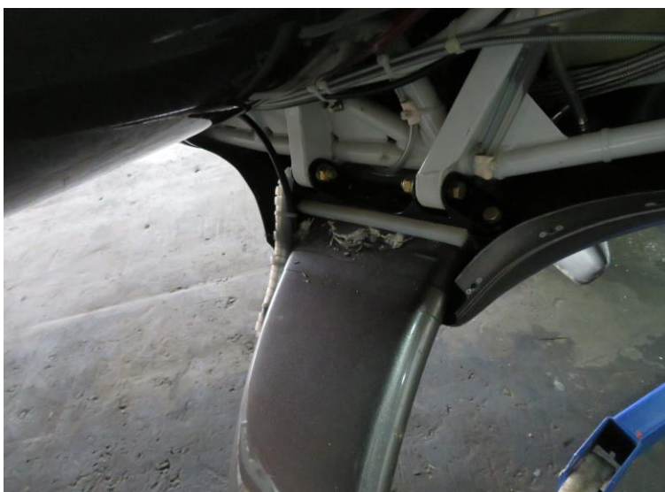
Rys. 4. Uszkodzona w miejscu mocowania prawa goleń podwozia głównego samolotu
