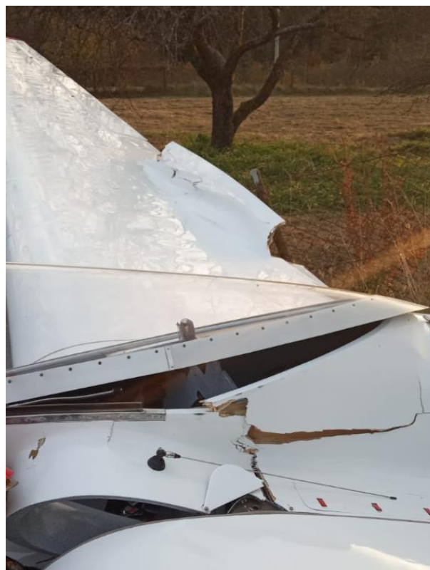
Rys. 4. Złamany kadłub i uszkodzone prawe skrzydło szybowca [źródło: użytkownik].
