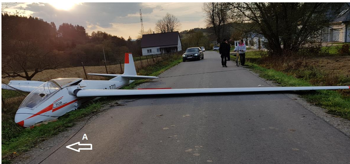
Rys. 2. Zdjęcie szybowca po zdarzeniu: A - zerwany kabel telefoniczny [źródło: użytkownik].
