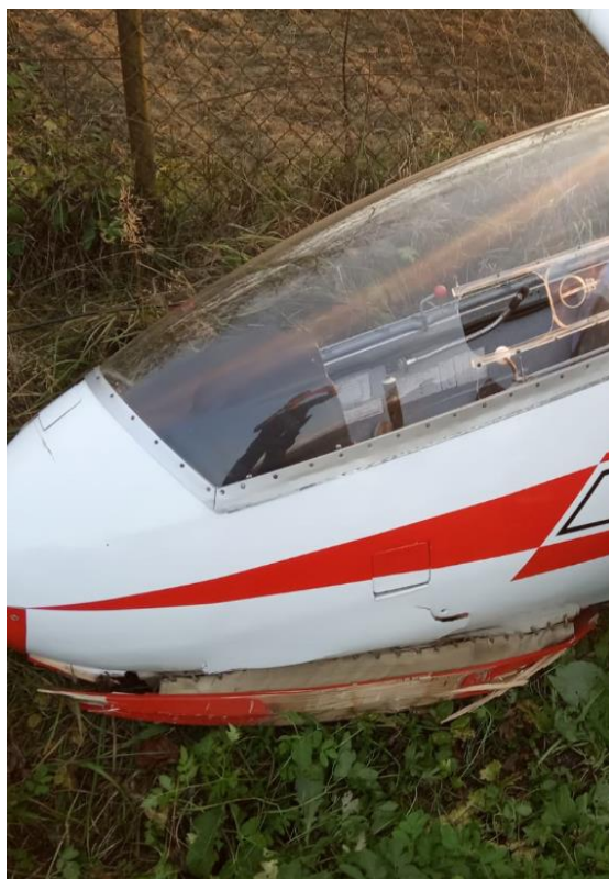
Rys. 3. Uszkodzony przód kadłuba i wyrwana płoza szybowca [źródło: użytkownik].
