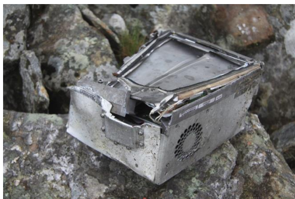
Rys.12. Znaleziony poza wrakiem, wyrwany z tablicy przyrządów pokładowych, poważnie uszkodzony wyświetlacz MFD. [foto Policja]
