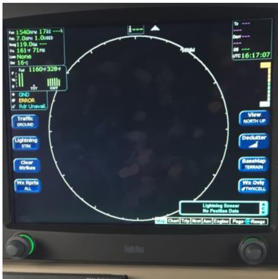
Rys.24. Widok ekranu na wyświetlaczu MFD–brak mapy, przy symulowanym uszkodzeniu lub braku komunikacji z GNS430 [foto T.Duda]
