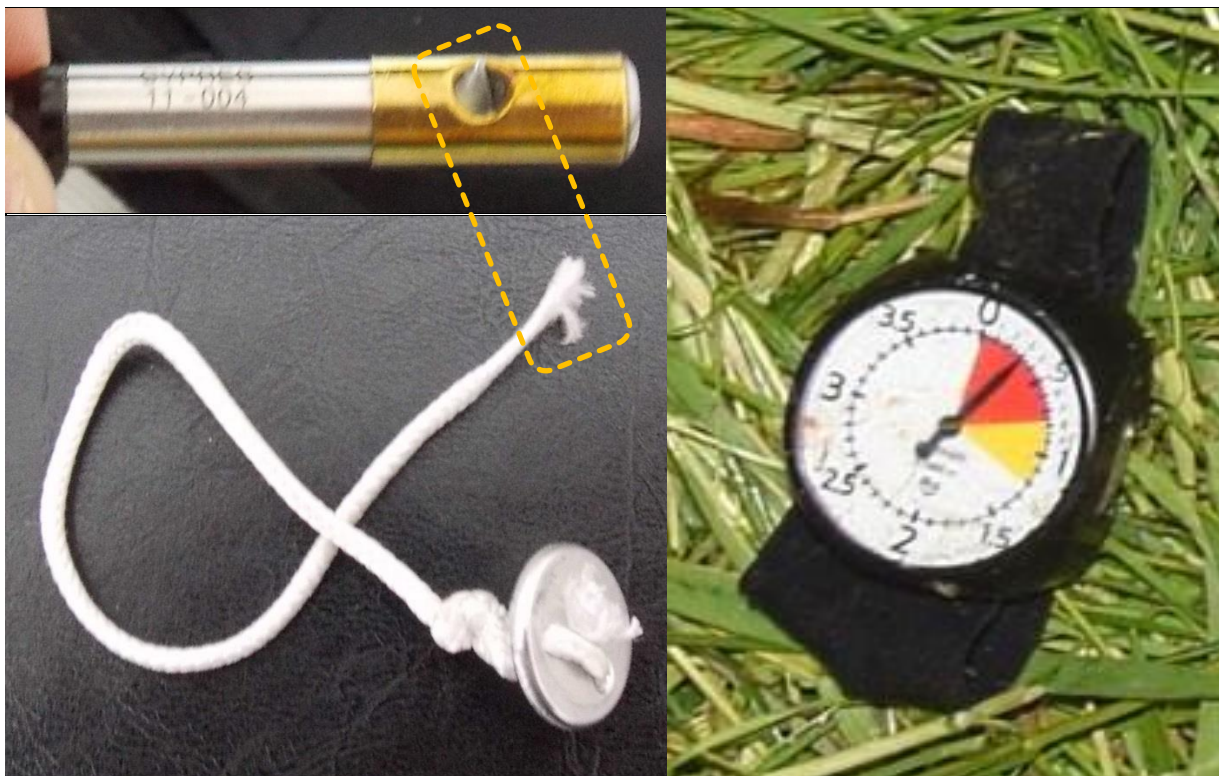
15, 16 – Cuter automatu Cypress 2 (u góry) i fragment przeciętej przez cutter pętli zamykającej pokrowiec czaszy zapasowej po zadziałaniu AAD i zainicjowaniu otwarcia spadochronu zapasowego [foto: PKBWL]
