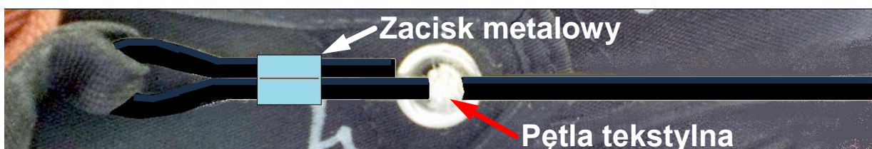
8 – Prawdopodobny wygląd elementu zastępczego (użytego zamiast RSE005) w stanie nieuszkodzonym. Element ten wykonano jako utrzymywaną metalowym zaciskiem pętlę z linki (cieńszej niż linka użyta na element RSE005) w osłonie z czarnego plastiku - w stanie zniszczonym widoczna na ilustracjach 9 i 10 poniżej.
