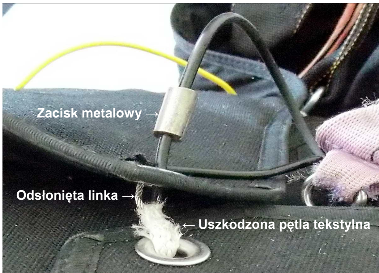
10 – Wyłogi pokrowca czaszy głównej – zbliżenie na uszkodzony element zastępczy („zawleczkę”) niewiadomego pochodzenia [foto: PKBWL].
