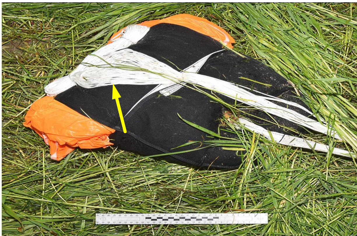
11 – Spadochron zapasowy w osłonce FreeBag , widoczne częściowo prawidłowo wyplecione linki (ich wyplecenie było skutkiem zderzenia z ziemią), wskazane żółtą strzałką [foto: KPP Przasnysz].
