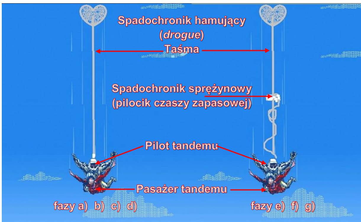
18 – Poglądowa ilustracja początku przebiegu zdarzenia. Z prawej strony pokazane splątanie spadochronika sprężynowego - pilocika czaszy zapasowej z taśmą spadochronika hamującego ( drogue ) ok. 1,5-2 m nad zespołem pilot-pasażer [via C.Subieta].
