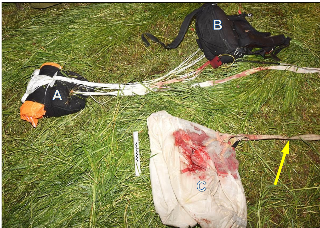
2 – Elementy systemu tandemowego sfotografowane na miejscu wypadku: A – spadochron zapasowy w osłonce FreeBag, B – spadochron główny w pokrowcu Advance Tandem z uprzężą pilota, C – czasza spadochronika hamującego (drogue) z taśmą łączącą FreeBag (taśma FreeBag wskazana strzałką) [foto: PKBWL].
