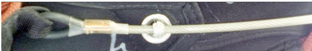
7 – Element RSE005 wg instrukcji systemu Advance Tandem na swoim miejscu w pokrowcu, prawidłowo blokujący wyłogi pokrowca czaszy głównej [via C.Subieta].
