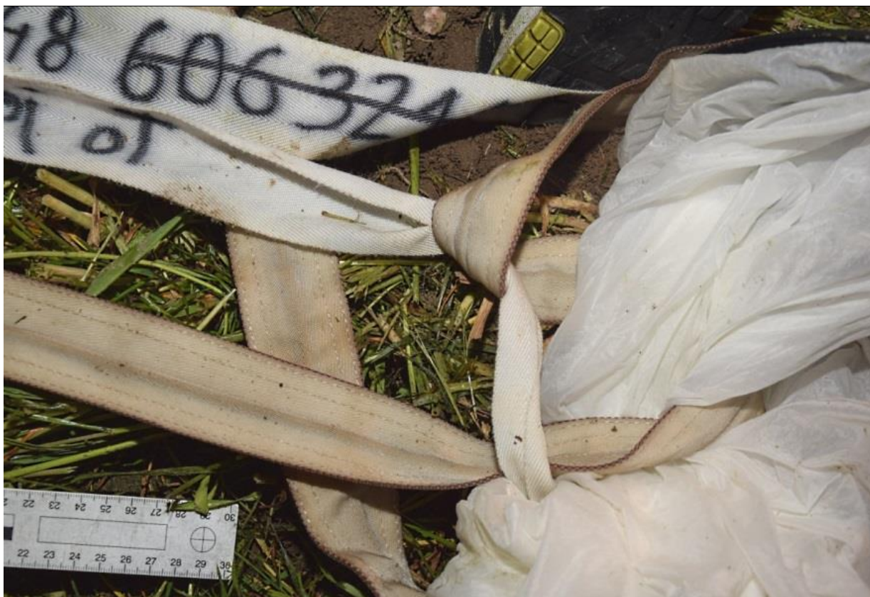
4 – Czasza spadochronika (pilocika) czaszy zapasowej z taśmą FreeBag, wplątana w taśmę łączącą pilocik czaszy głównej (drogue) – zbliżenie fragmentu z ilustracji 3 objętego czerwonym prostokątem [foto: PKBWL].
