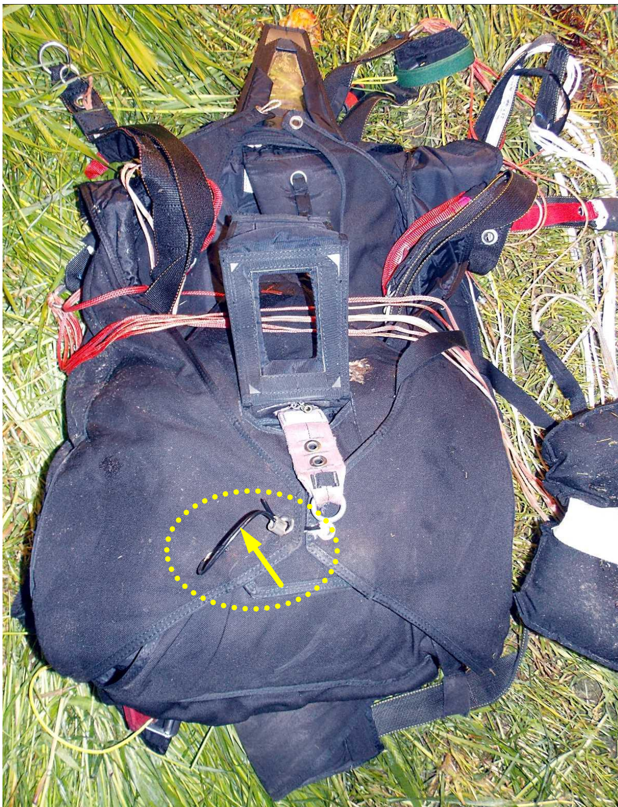
5 – Zamknięty pokrowiec Advance Tandem czaszy głównej. Zaznaczony uszkodzony element blokujący zastępczy („zawleczka”) niewiadomego pochodzenia, użyty zamiast przewidzianego przez Wytwórcę elementu prawidłowego (zawleczki RSE005) pokazanej poniżej na ilustracji 6 [foto: PKBWL].
