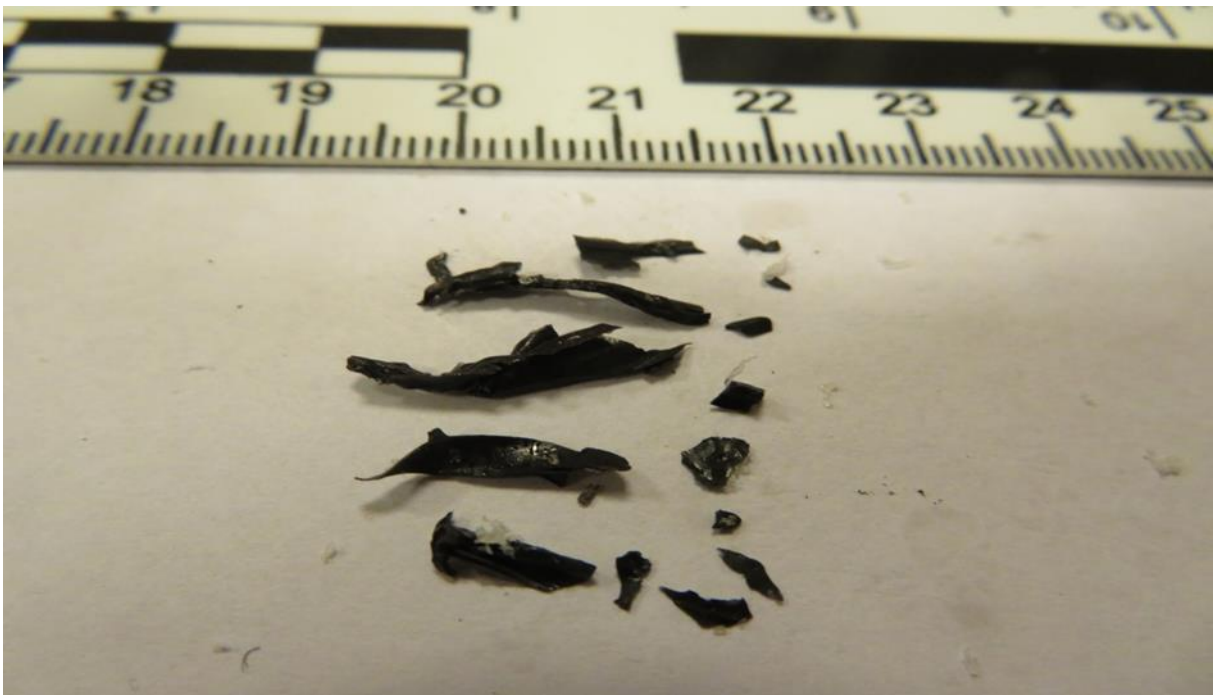
Rys 5- Kawałki gumy wyjęte z filtra paliwa (Źródło PKBWL)
