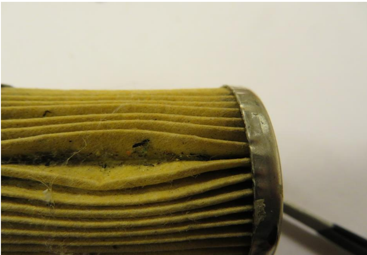
Rys 6- Zanieczyszczony filtr paliwa (Źródło PKBWL)
