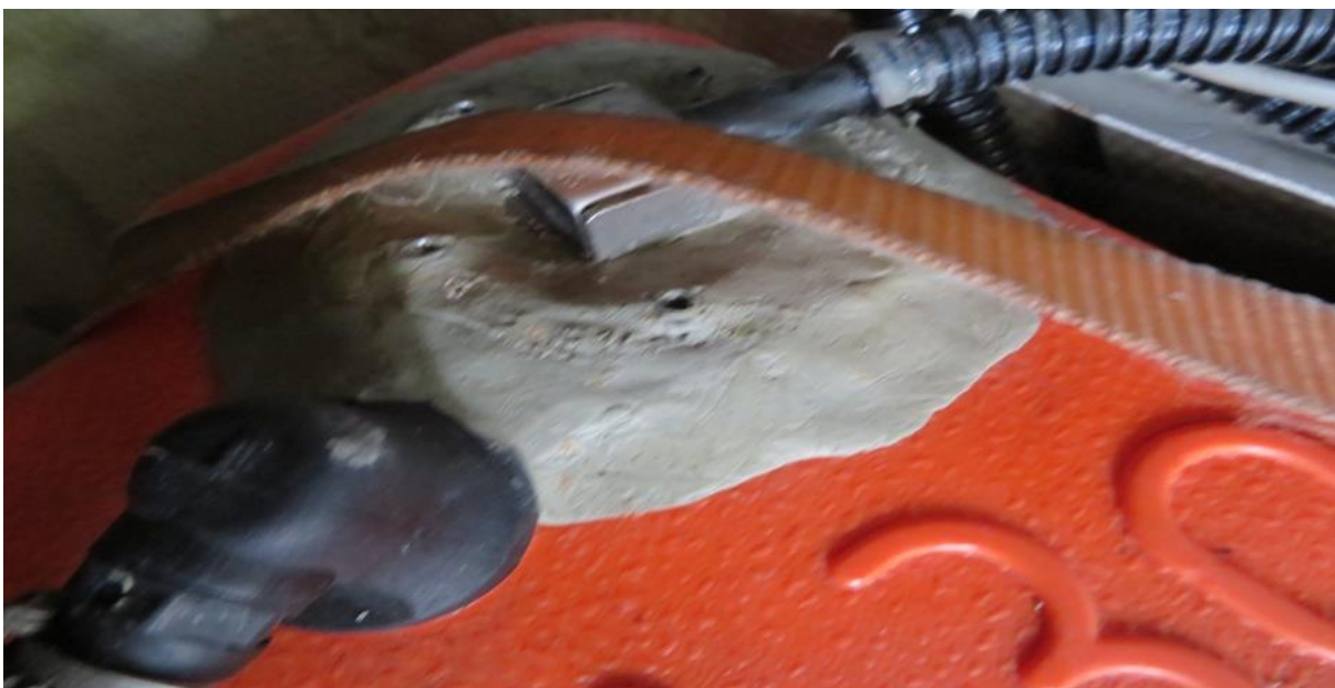
Rys 7- Ślady naprawy końcówki ssącej przewodu paliwowego (Źródło PKBWL).
