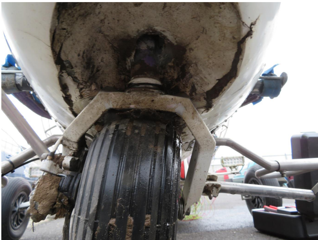
Rys. 1 - Uszkodzone przednie koło i dolna powierzchnia wózka (Źródło PKBWL)
