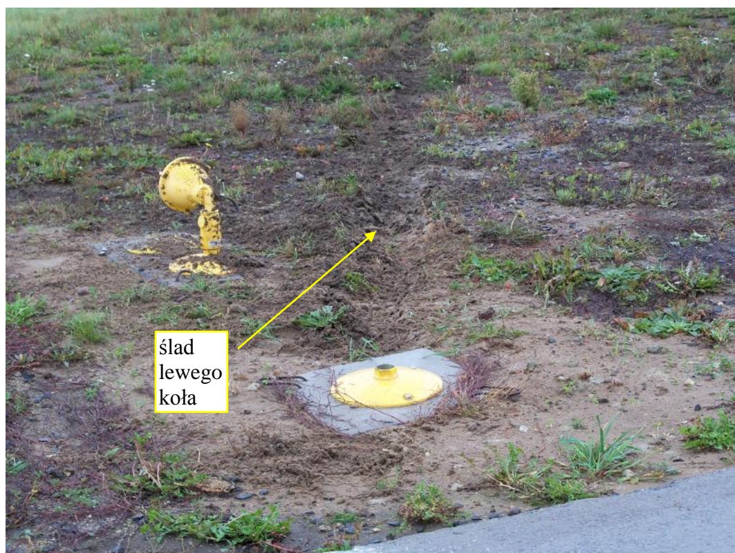
Fot. 8. Uszkodzona lampa końca drogi startowej oraz ślad lewego koła podwozia głównego przy progu THR26.
