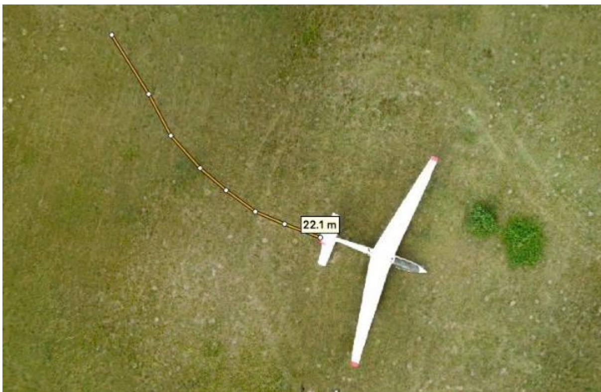
Rys. 1. Miejsce zdarzenia – ślady dobiegu widoczne z góry [źródło: FlyTech UAV]
