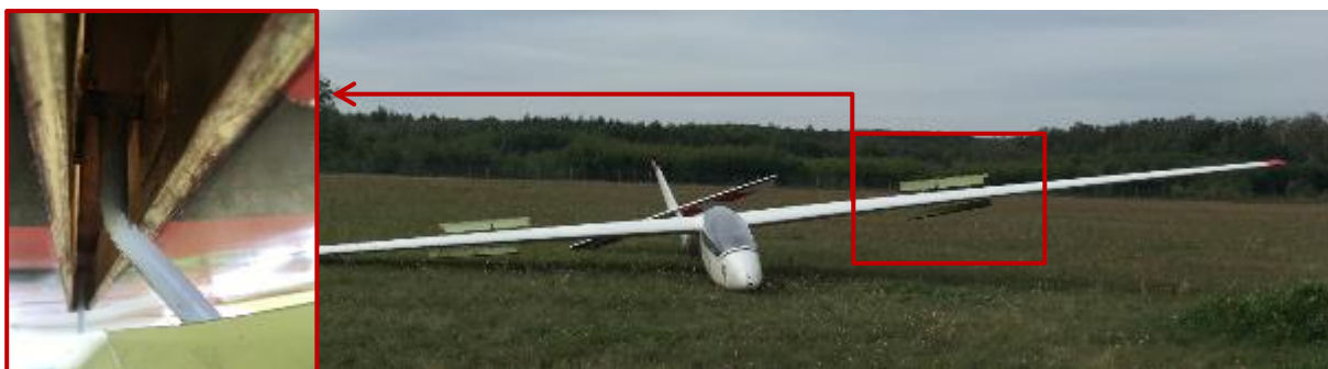
Rys. 3. Miejsce zdarzenia – widok szybowca od przodu (w widoku z lewej pokazany szczegół – uszkodzone hamulce aerodynamiczne) [źródło: PKBWL]
