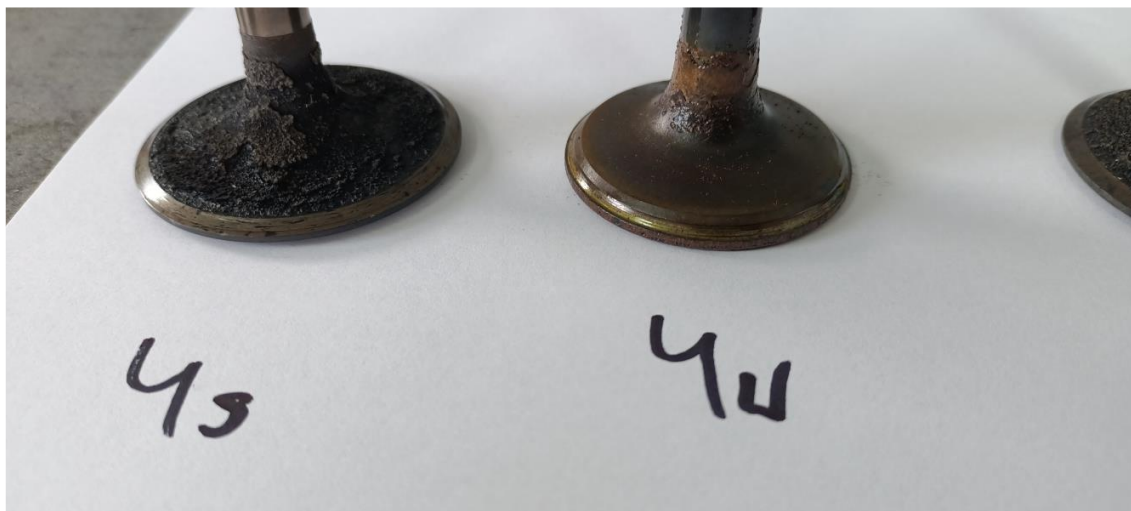
Rys.9 Nagar oraz nadmierne zużycie przyłgni grzybków zaworów.
