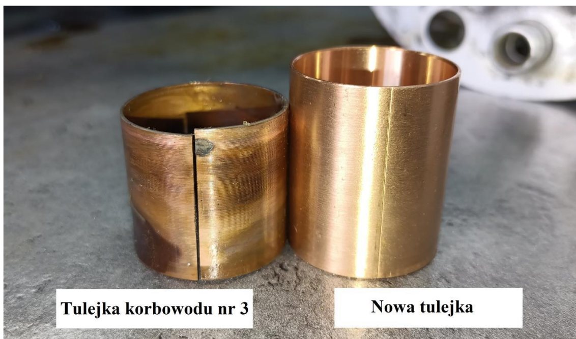
Rys.10 Uszkodzona tulejka korbowodu.
