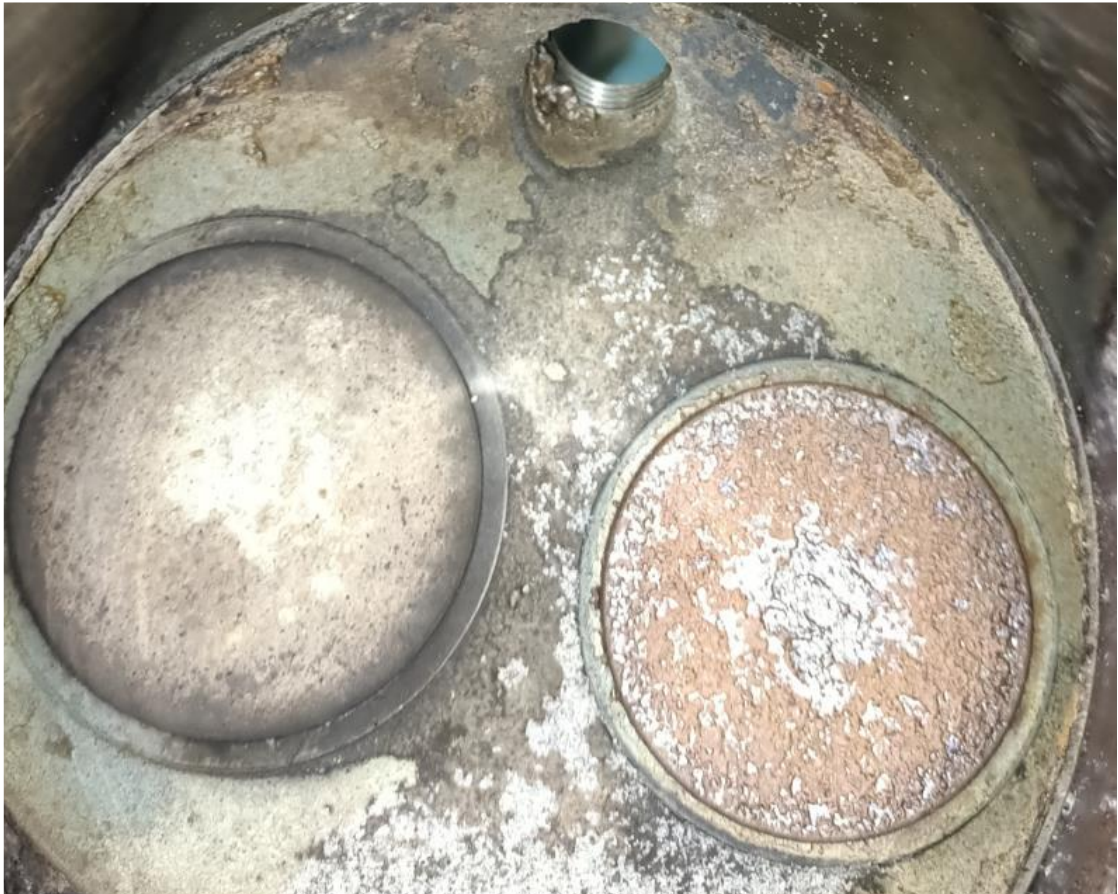
Rys.5 Nagar wewnątrz cylindra oraz na zaworach.
