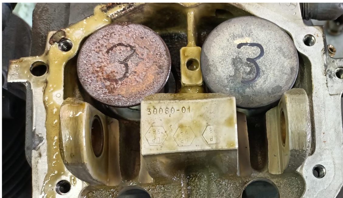
Rys.8 Widok przegrzanych zaworów nr 3.
