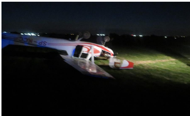
Rys. 1. Widok samolotu po kapotażu [źródło: PKBWL].
