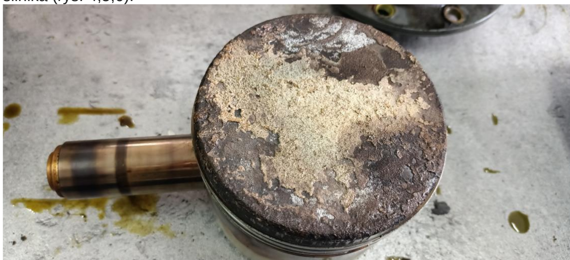
Rys.4 Widoczny nagar na powierzchni tłoka.
