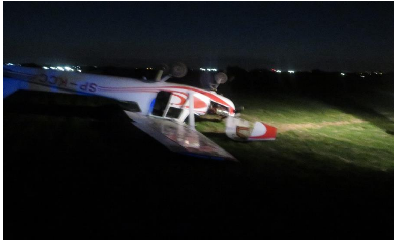
Rys. 1. Widok samolotu po kapotażu [źródło: PKBWL].
