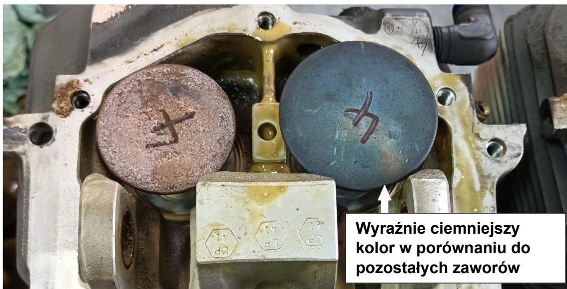
Rys.2 Widok przegrzanego zaworu ssącego nr 4.
