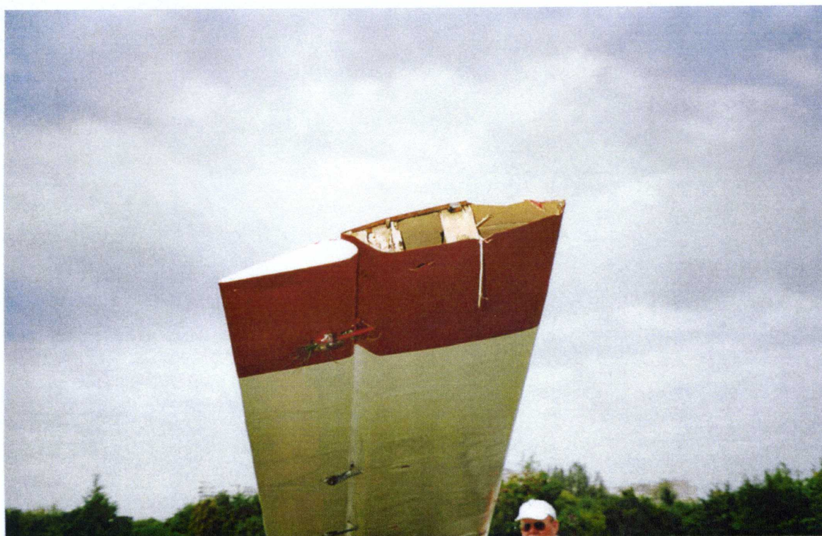
Ryc. 4 Uszkodzona końcówka prawego skrzydła
