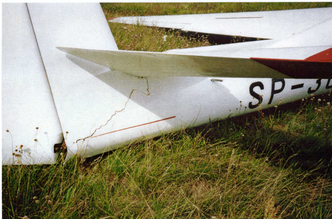
Ryc. 5 Pęknięty kadłub – strona prawa
