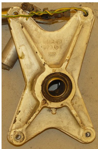
27, 28 – Uszkodzone okucie przednie po demontażu (z lewej) i okucie nowe (z prawej).
