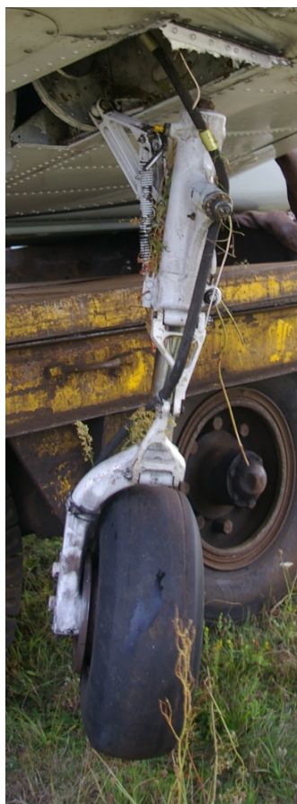
21, 22, 23 – Oderwane prawe podwozie główne pokazane w różnych ujęciach.
