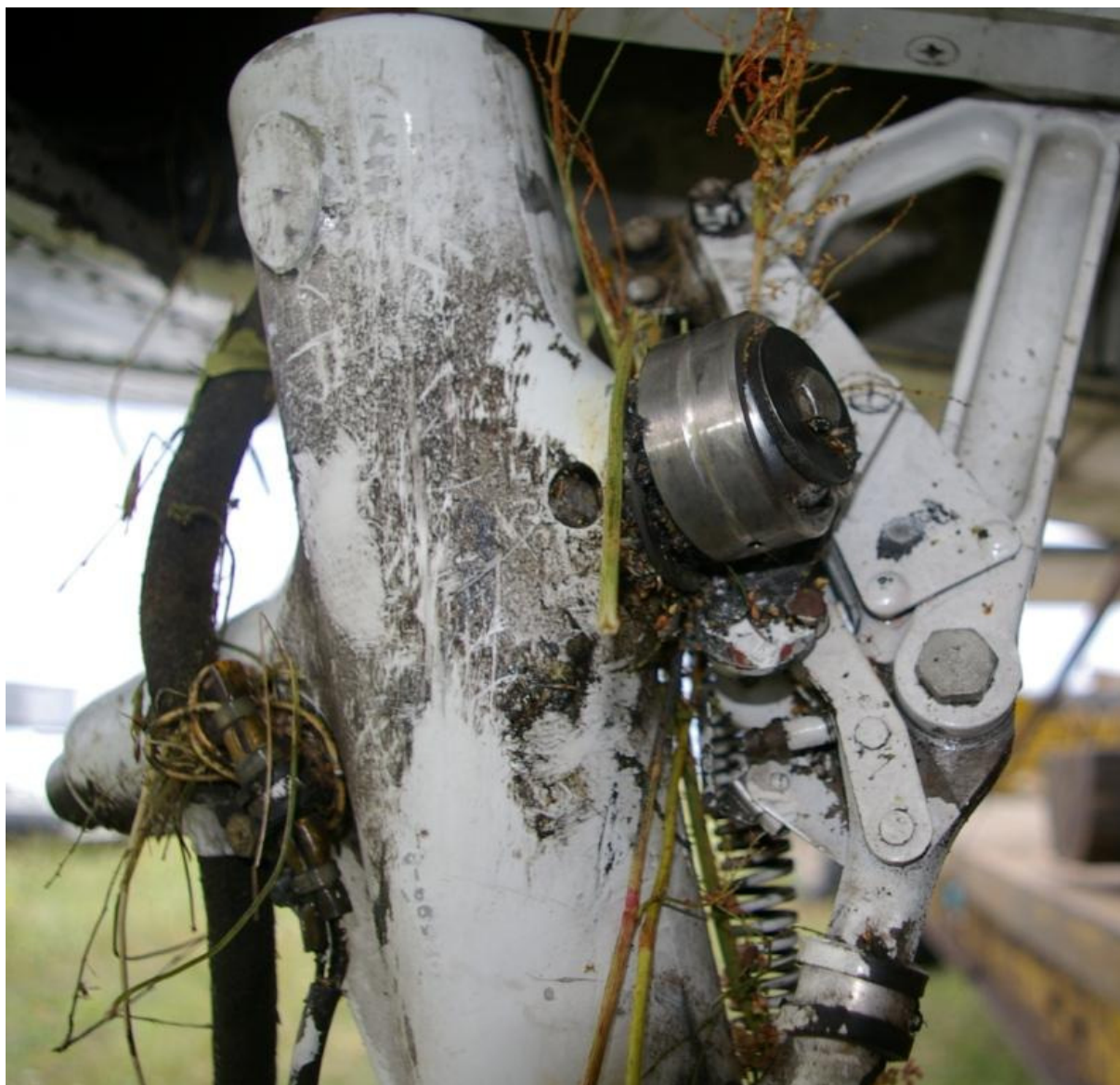
31 - Ogólny widok wyrwanego z okuć na płatowcu prawego podwozia głównego. Na pierwszym planie czop współpracujący z okuciem przednim (z zachowanym łożyskiem).
