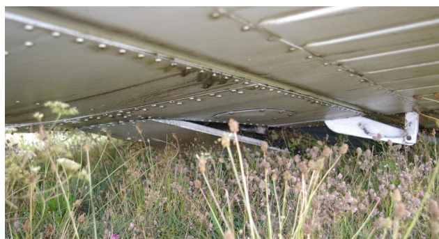
18 – Spód lewego skrzydła. Widoczne nie w pełni schowane lewe podwozie główne.
