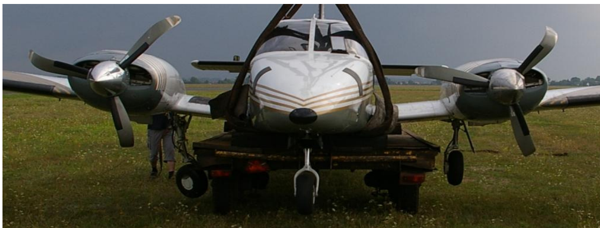
20 – Ogólny widok samolotu podczas załadunku, dobrze widoczny stan śmigieł i wszystkich zespołów podwozia.
