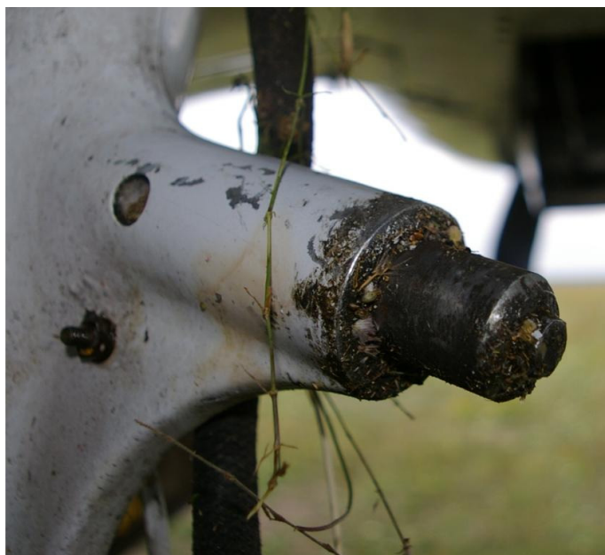
32 - Czop współpracujący z okuciem tylnym – zbliżenie.
