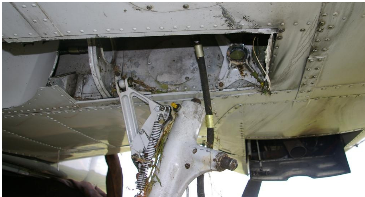
24 – Widok na wnękę prawego podwozia głównego i ściankę dźwigara skrzydła. Widoczne uszkodzone okucie przednie.
