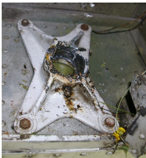
24 – Uszkodzone okucie przednie na samolocie.
