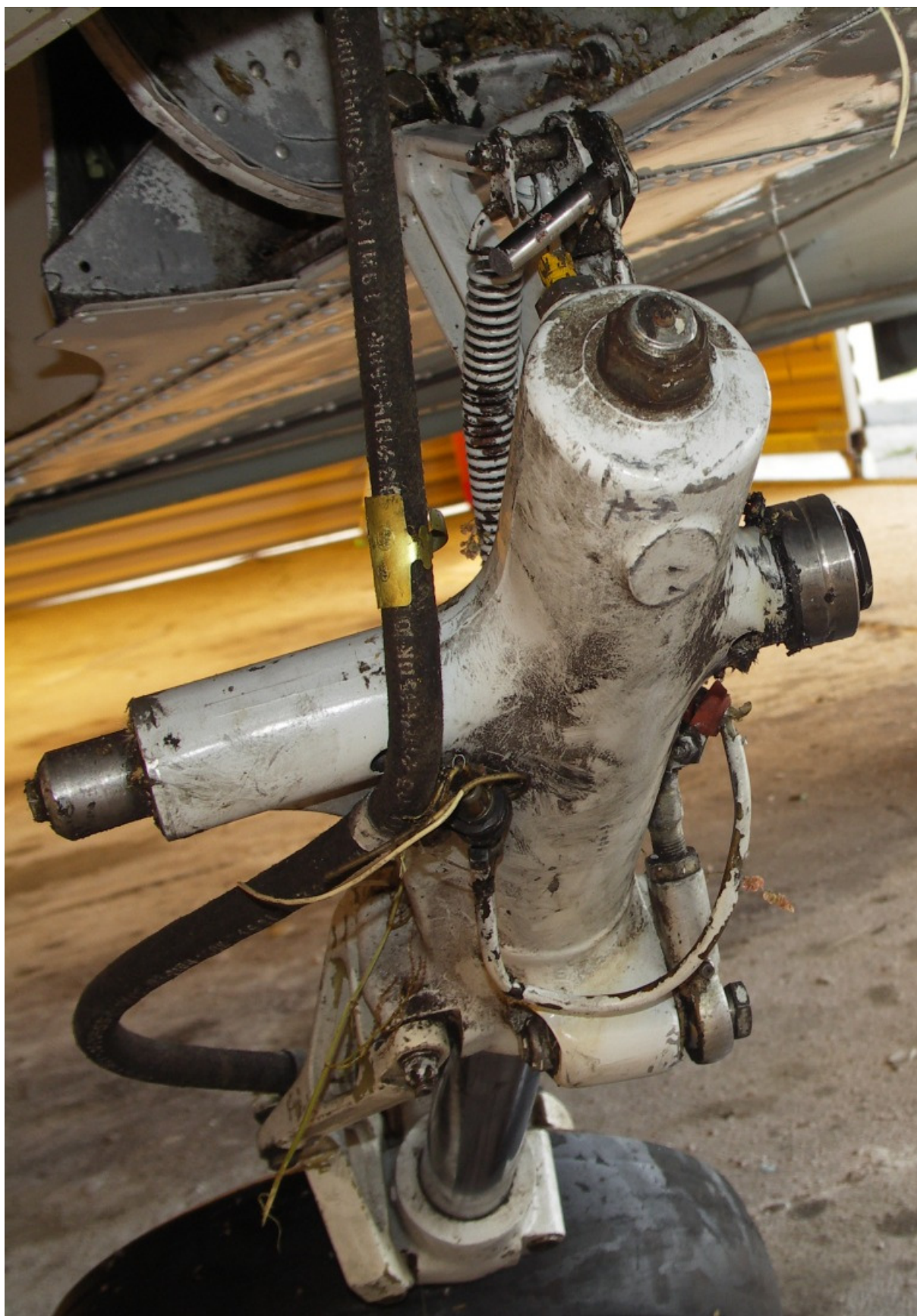
30 – Ogólny widok wyrwanego z okuć na płatowcu prawego podwozia głównego. Po lewej stronie czop współpracujący z okuciem tylnym (bez łożyska), po prawej – czop współpracujący z okuciem przednim (z zachowanym łożyskiem).
