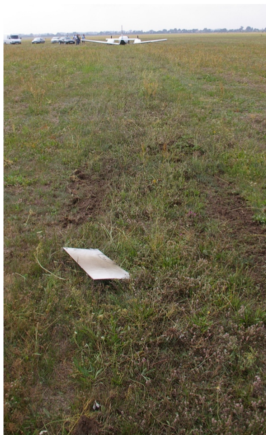
6 – Oderwana pokrywa luku prawego podwozia głównego.
