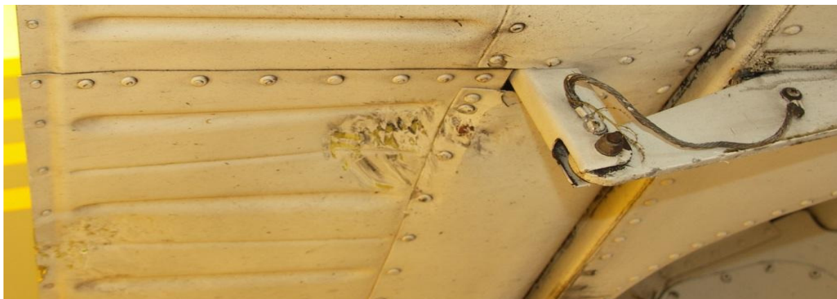
19 – Uszkodzenia spodu prawej klapy wskutek kontaktu z oderwanym podwoziem podczas przyziemienia.
