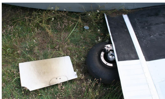
17 – Wyrwane prawe podwozie główne wystające spod skrzydła. Widoczne uszkodzenie kłapy. Za kołem pokrywa luku podwozia.
