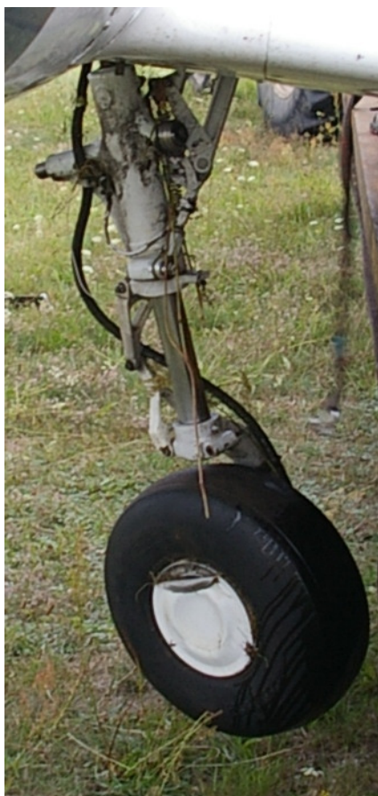
21, 22, 23 – Oderwane prawe podwozie główne pokazane w różnych ujęciach.
