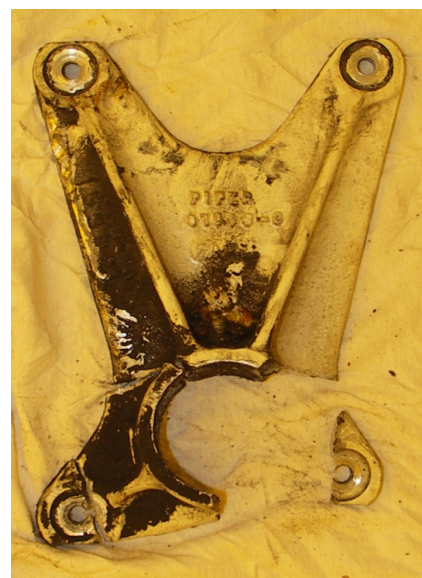
29 – Zniszczone okucie tylne po demontażu.
