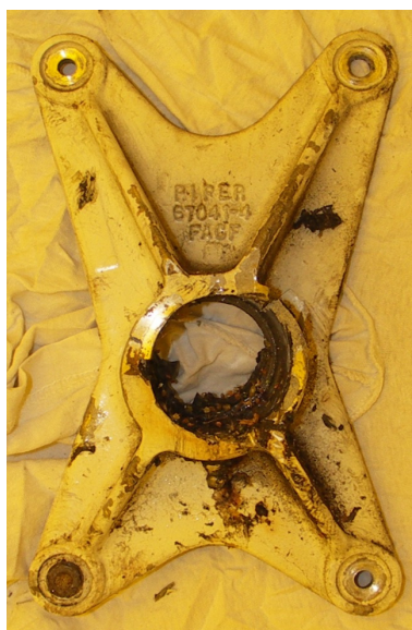
27, 28 – Uszkodzone okucie przednie po demontażu (z lewej) i okucie nowe (z prawej).
