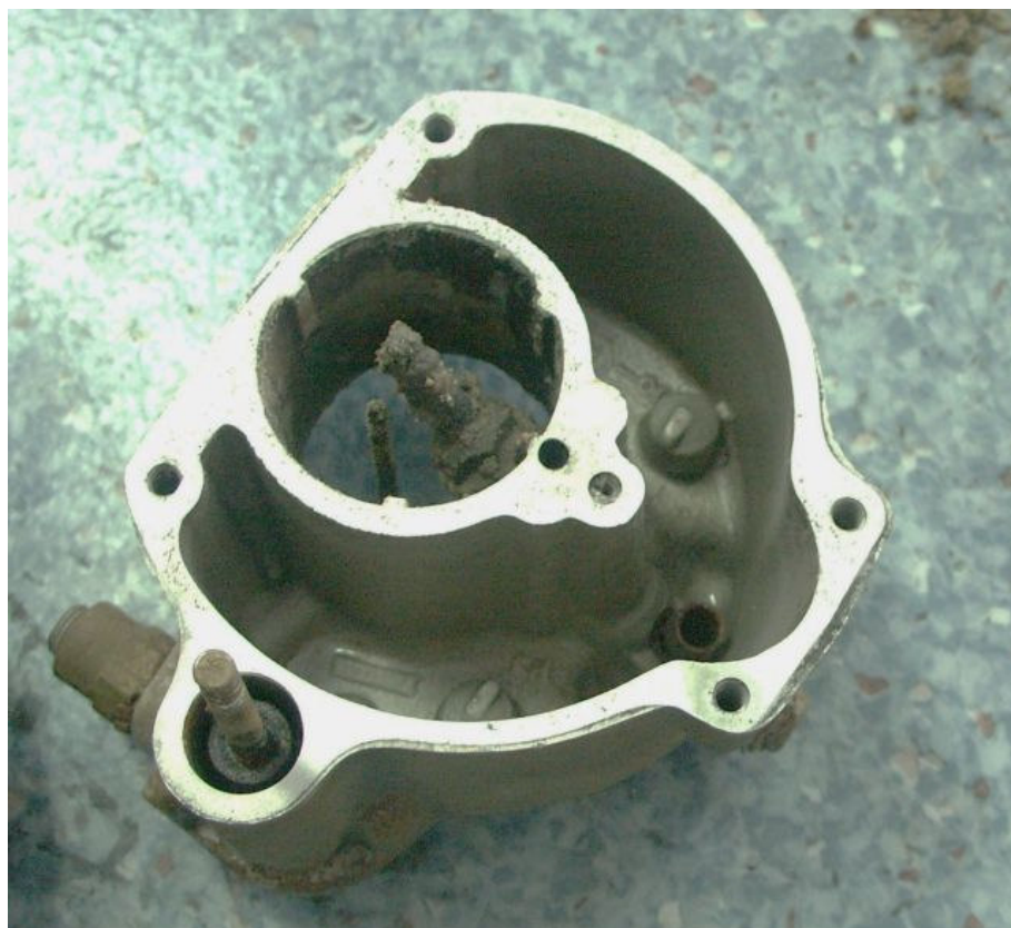
87. Widok na wnętrze gaźnika. Komora paliwowa czysta – bez osadów żywic, piasku i szlamu.
