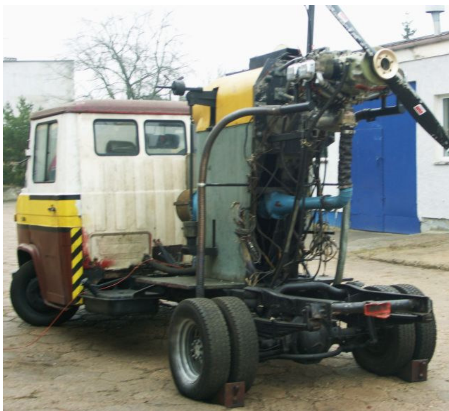
94, 95. Stoisko hamowniane na terenie certyfikowanego warsztatu remontowego z zamontowanym silnikiem z samolotu SP-KCP.
