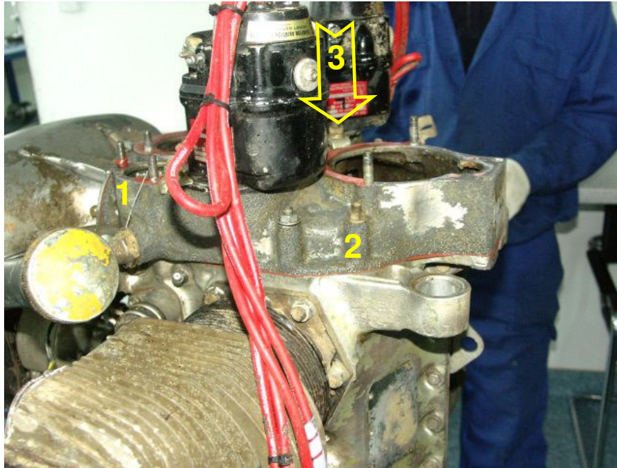
81. Zdjęcie obudowy skrzyni napędów. Cyfry wskazują miejsca wykonania zdjęć pokazanych dalej, na których widoczne są zniszczenia (wżery) powstałe po ok. 7-tygodniowym przebywaniu silnika w Wiśle.
