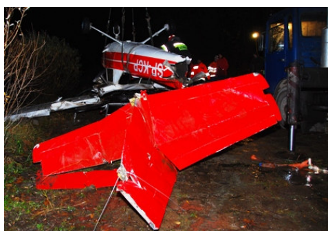
49, 50. Na lewym dolnym zdjęciu widoczny ułamany w trakcie holowania ogon samolotu (fragment kadłuba wraz z usterzeniem). Na prawym – przyczepa transportowa z załadowanym kadłubem i jednym skrzydłem.
