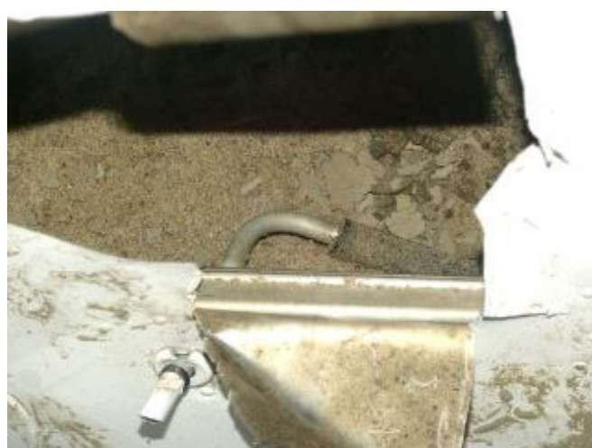
54 ÷ 56. Zdjęcia skrzydła z częściowo usuniętym pokryciem pokazują nagromadzony piasek w trakcie ok. 7-tygodniowego przebywania samolotu w nurcie rzeki.
