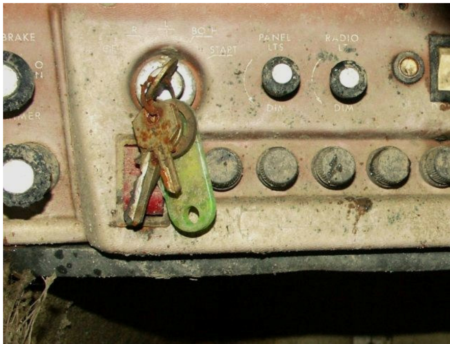
63. Stacyjka (wyłącznik zapłonu) w pozycji „Oba iskrowniki włączone” (BOTH).
