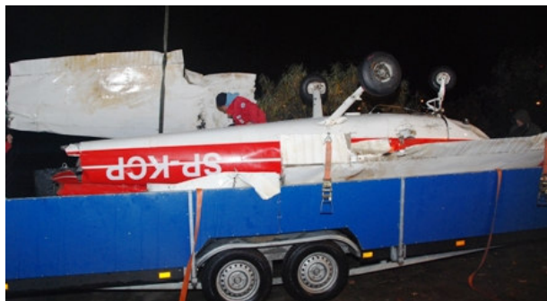
49, 50. Na lewym dolnym zdjęciu widoczny ułamany w trakcie holowania ogon samolotu (fragment kadłuba wraz z usterzeniem). Na prawym – przyczepa transportowa z załadowanym kadłubem i jednym skrzydłem.
