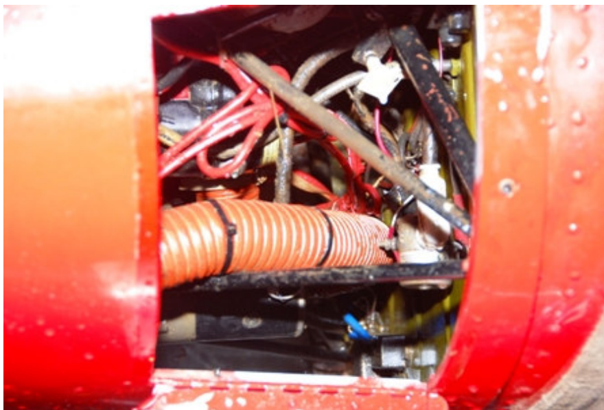
46. Wnętrze zespołu napędowego przez wziernik na prawej osłonie silnika. Wnętrze pod osłonami silnika bez widocznego piasku i zanieczyszczeń z rzeki.
