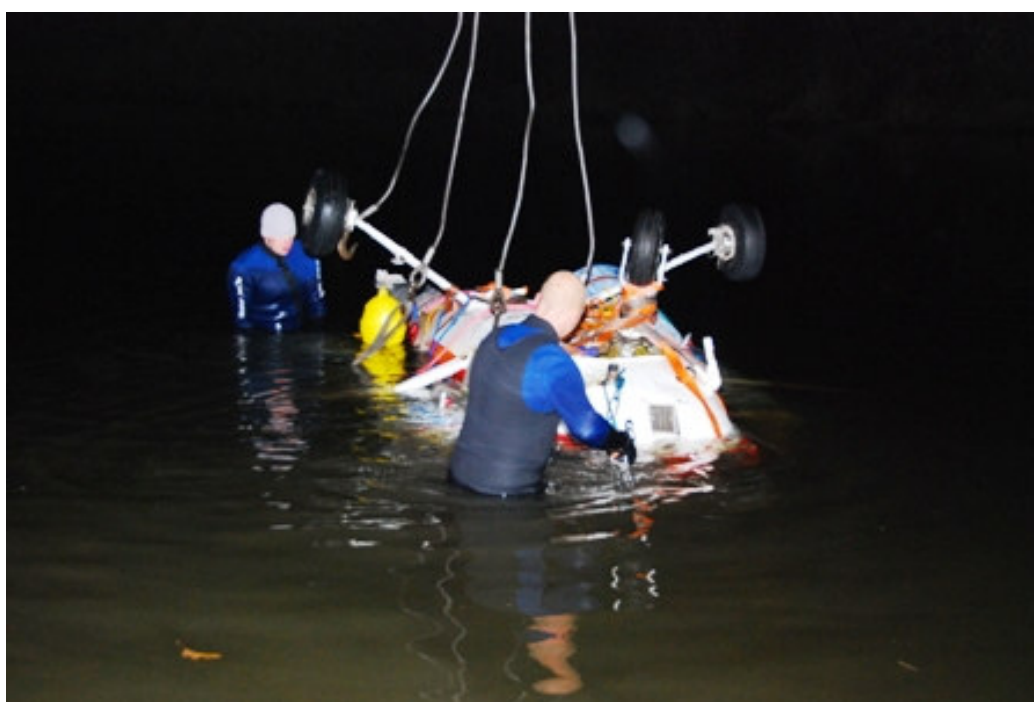
35, 36. Samolot odholowany do tzw. „kanału zimowego”, obok śluzy żerańskiej. Na dolnym zdjęciu mocowanie lin i pasów do podniesienia samolotu.
