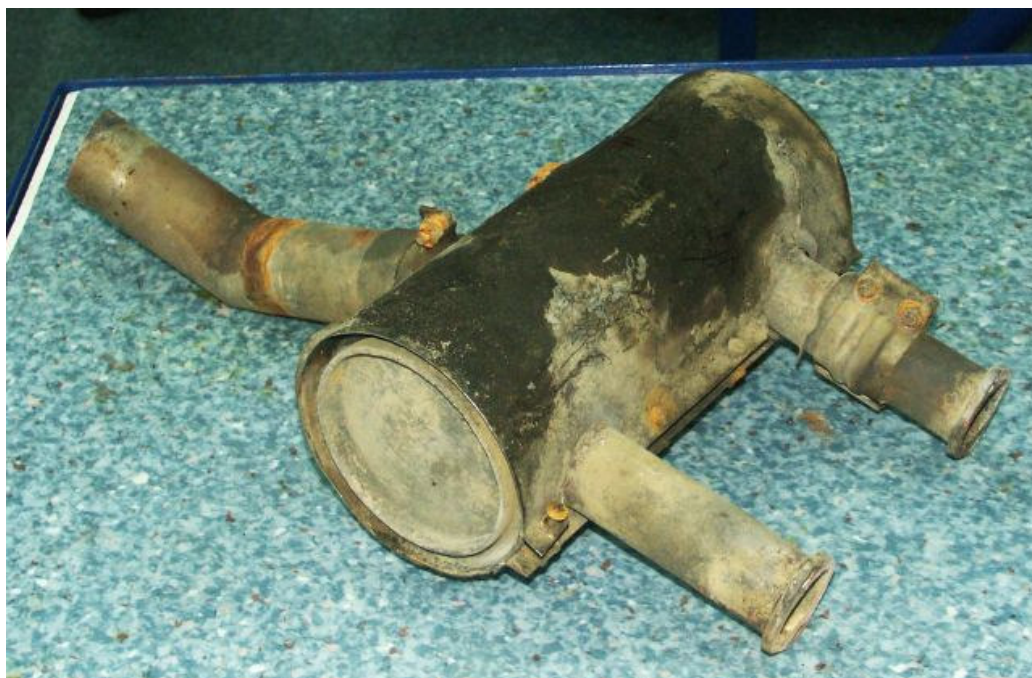
90. Widok na zdemontowany kolektor prawy z zamontowaną nagrzewnicą powietrza do gaźnika. Po zdemontowaniu nagrzewnicy (pokazano na dalszych zdjęciach) sprawdzono szczelność kolektora. Nieszczelny kolektor mógłby spowodować zasysanie do gaźnika spalin zamiast powietrza, co mogłoby doprowadzić do zmniejszenia mocy silnika.
