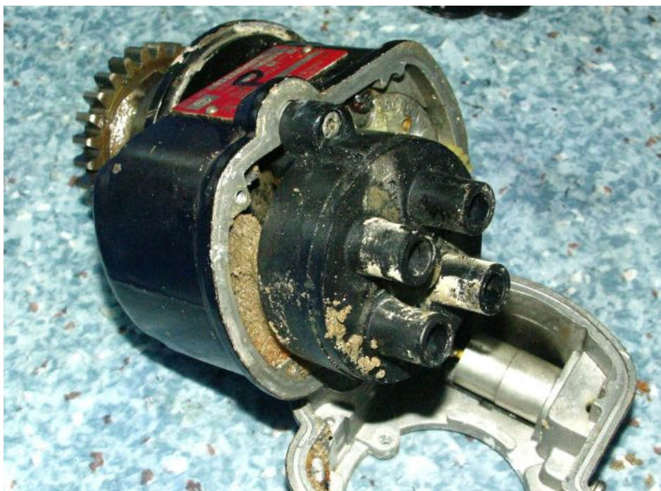
88. Iskrownik zanieczyszczony piaskiem (zbliżenie pokazane na następnym zdjęciu). Taki stan iskrownika wymusił jego rozebranie i oczyszczenie przed próbą uruchomienia silnika.
