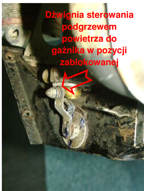
77, 78. Dźwignia podgrzewu powietrza do gaźnika w pozycji zablokowanej i po minięciu tej pozycji.
