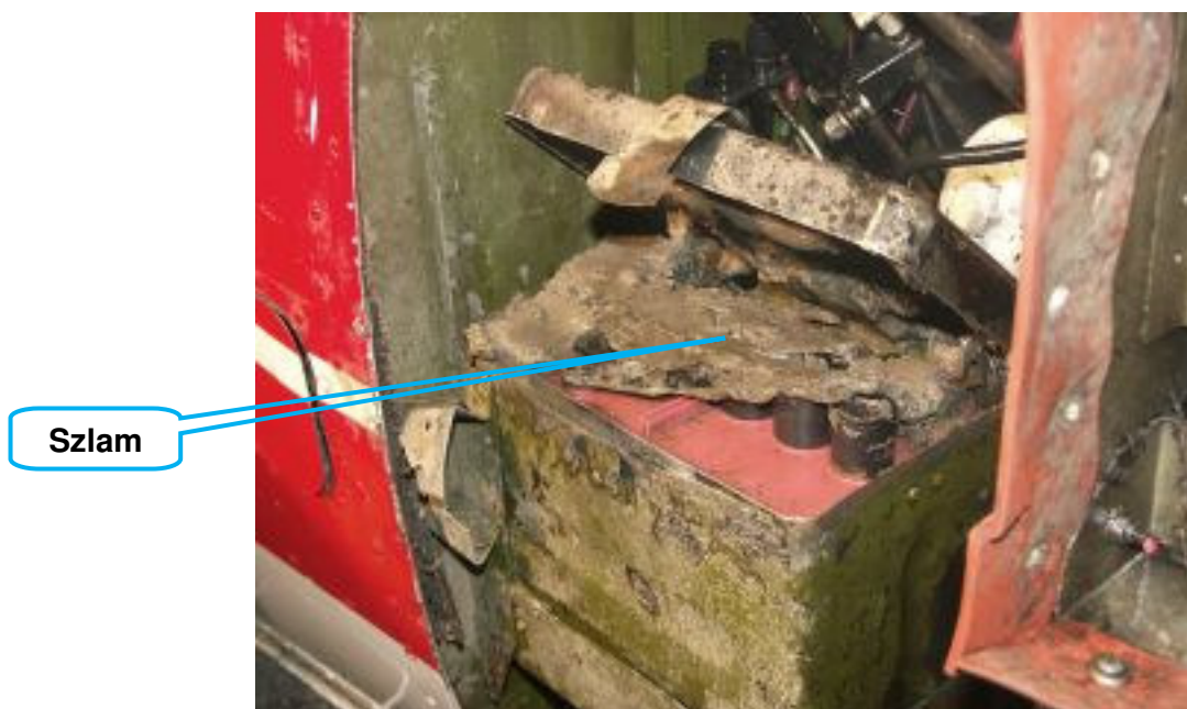
57, 58. Zdjęcia wału śmigła i kasety akumulatora pokazują nagromadzony szlam w trakcie ok. 7-tygodniowego przebywania samolotu w nurcie rzeki.
