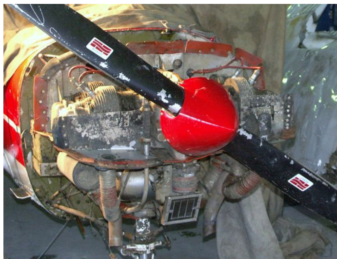
67 ÷ 69. Stan zespołu napędowego po zdjęciu osłon.
