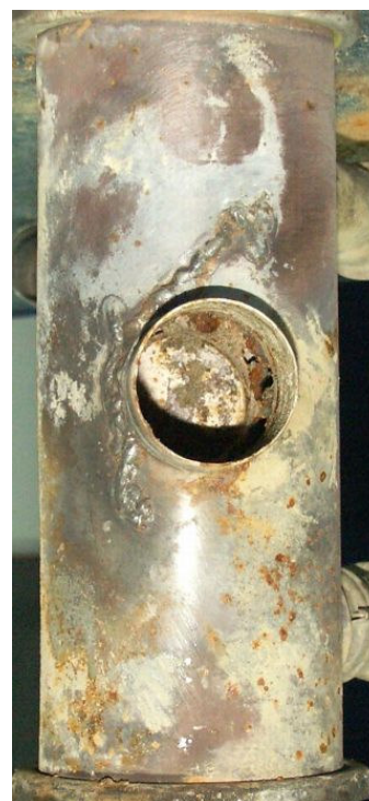
92, 93. Przy kołnierzu rury wydechowej znaleziono naprawę spawalniczą. Ponieważ spaw był mocno skorodowany oczyszczono go celem sprawdzenia (prawe zdjęcie). Stwierdzono, że spaw jest szczelny.
