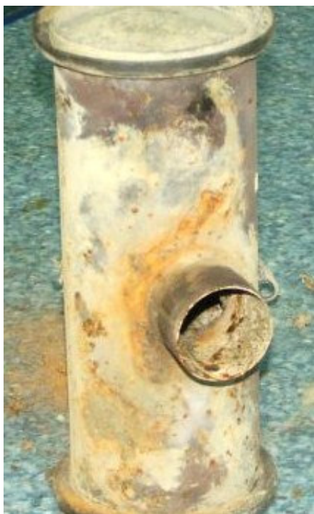
92, 93. Przy kołnierzu rury wydechowej znaleziono naprawę spawalniczą. Ponieważ spaw był mocno skorodowany oczyszczono go celem sprawdzenia (prawe zdjęcie). Stwierdzono, że spaw jest szczelny.
