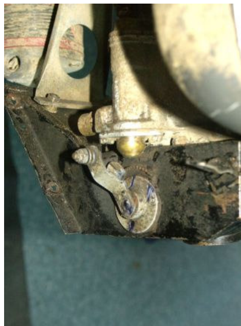
77, 78. Dźwignia podgrzewu powietrza do gaźnika w pozycji zablokowanej i po minięciu tej pozycji.
