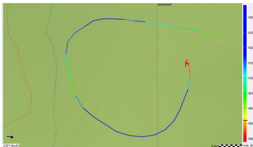
Rys. 6 Zapis trajektorii lotu. Skala wysokości podaje wartości ponad poziom morza (elewacja lotniska EPBA to 401 m AMSL). Kierunek wiatru, zobrazowany strzałką w lewym dolnym rogu, jest prawidłowy, jednak wartość prędkości nie jest miarodajna – wynika ze zbyt krótkiego czasu próbkowania urządzenia.
