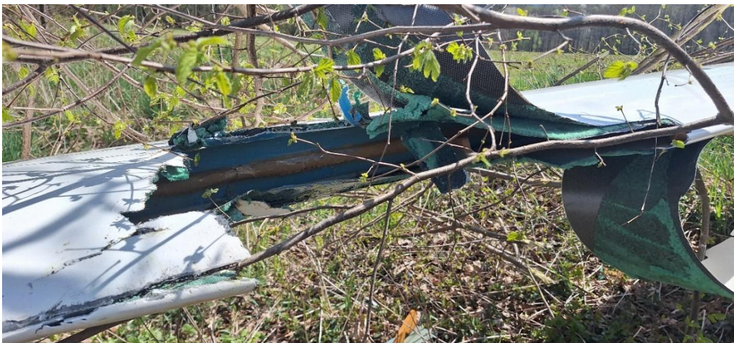
Rys. 3 Rozerwany w wyniku uderzenia o pień drzewa keson lewego skrzydła [źródło: PKBWL]
