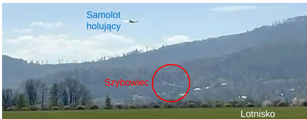
Rys. 1 Zespół samolot-szybowiec po wyczepieniu liny przez pilota szybowca (tuż przed zderzeniem szybowca z przeszkodami) – widok na S [źródło: materiał zabezpieczony przez PKBWL]
