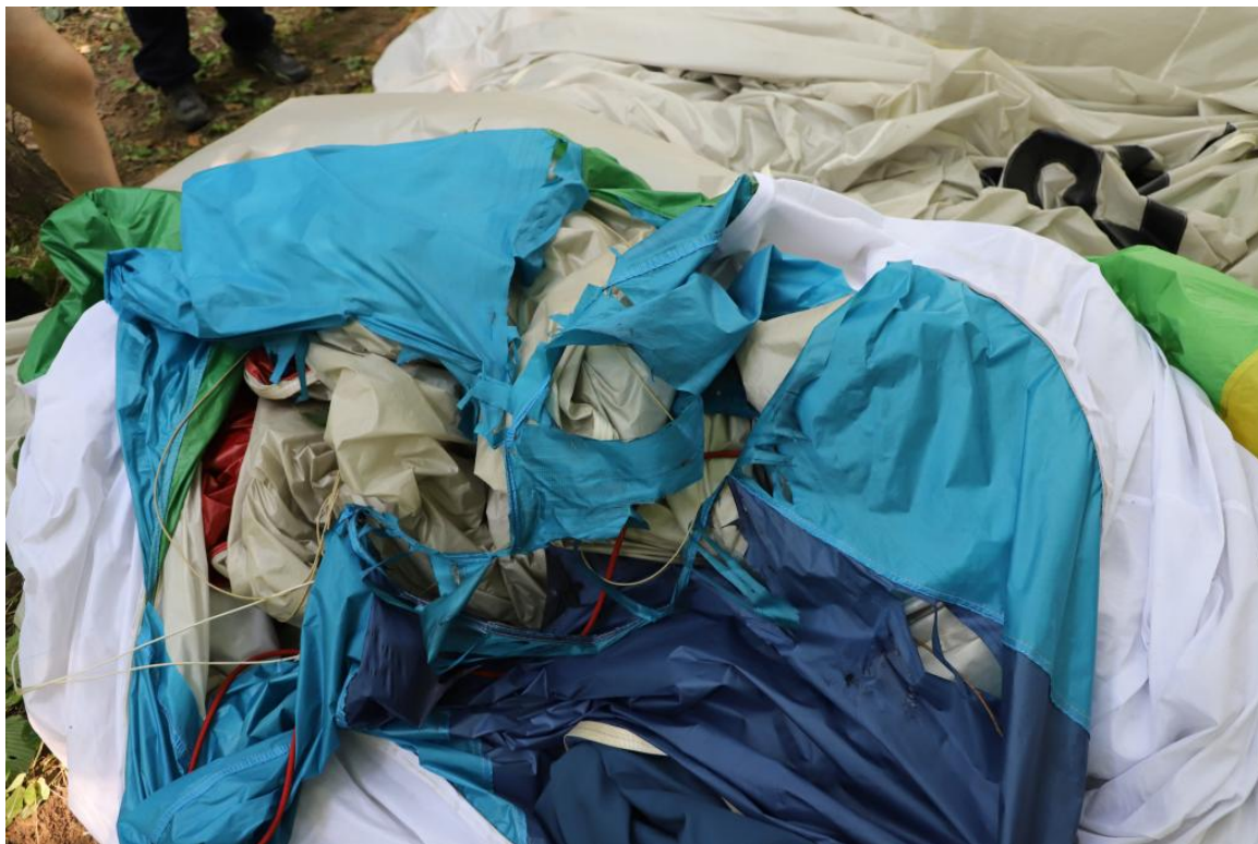
Rys. 4. Uszkodzenia powłoki balonu SP-BOC.
